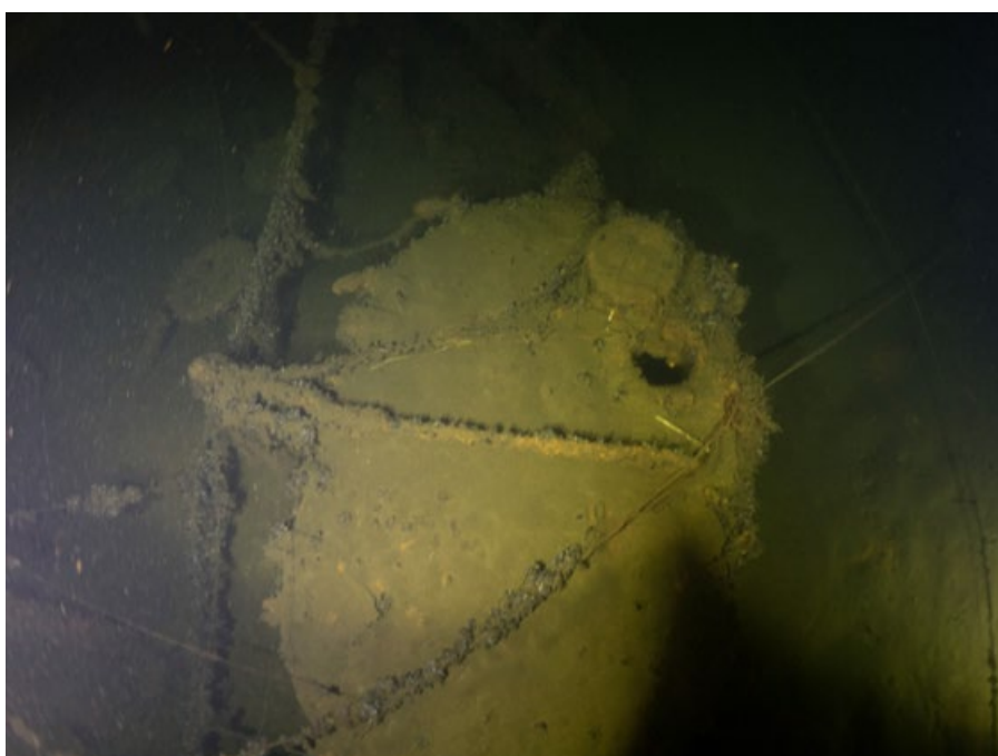
Zdjęcie 20. Pokrywa zbiornika paliwa na lewej burcie przy dziobowej nadbudówce – widoczny otwarty właz rewizyjny. Jeżeli w zbiorniku było paliwo lekkie – zbiornik jest już pusty, jeżeli paliwo ciężkie – konieczna jest inspekcja wewnątrz zbiornika w celu potwierdzenia lub wykluczenia obecności paliwa (źródło: ekspedycja 2018, fot. M. Czermiński)
